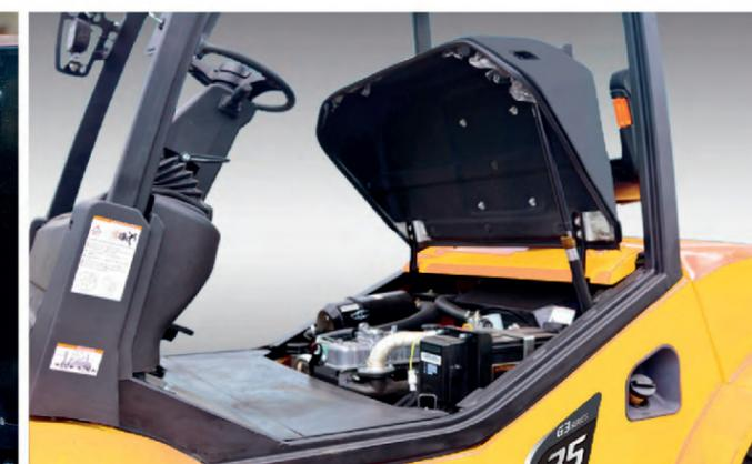
Copertura del motore con ampio angolo di lavoro, ampio spazio per la manutenzione
